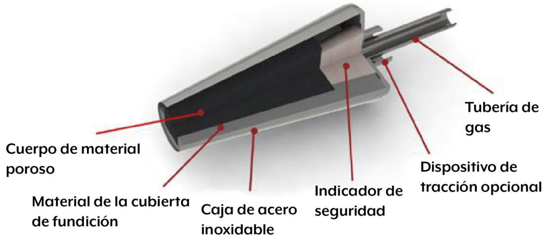
La tecnología de refinación secundaria es la parte más importante del proceso de fabricación de acero. Puede ajustar el tipo de aleación de acero y la temperatura del líquido. El tapón y el bloque de purga son los componentes funcionales clave de este proceso..
